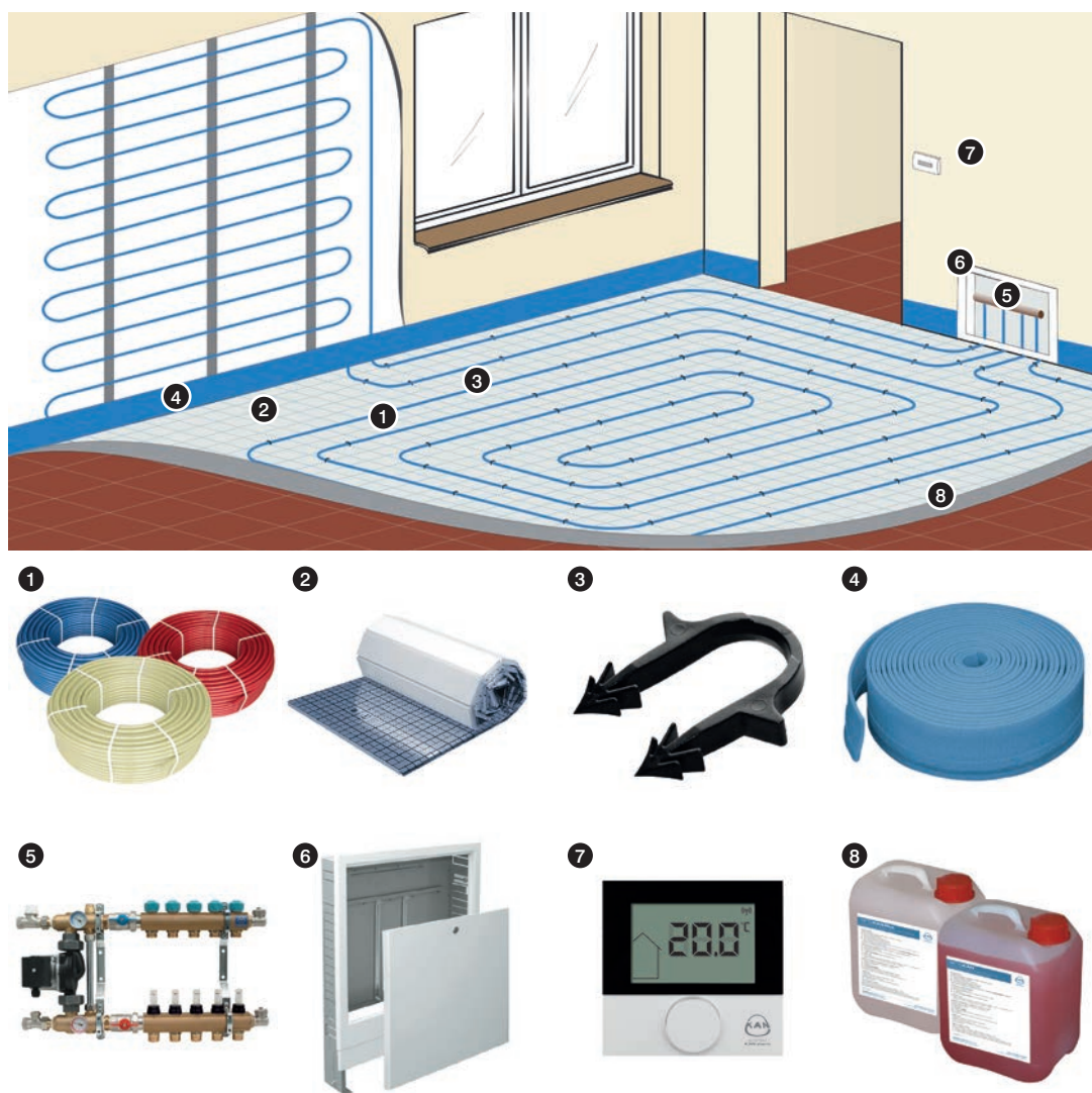
Рис. 46. Элементы панельного отопления/охлаждения KAN-therm
