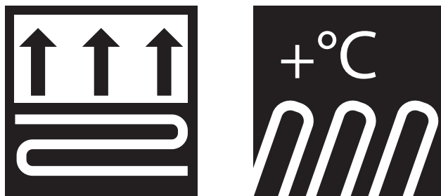
Рис. 20. Примеры маркировки материалов, используемых в подпольном отоплении
